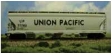
عربة هوبر مغطاة لنقل الحبوب (حتى 100 طن)
