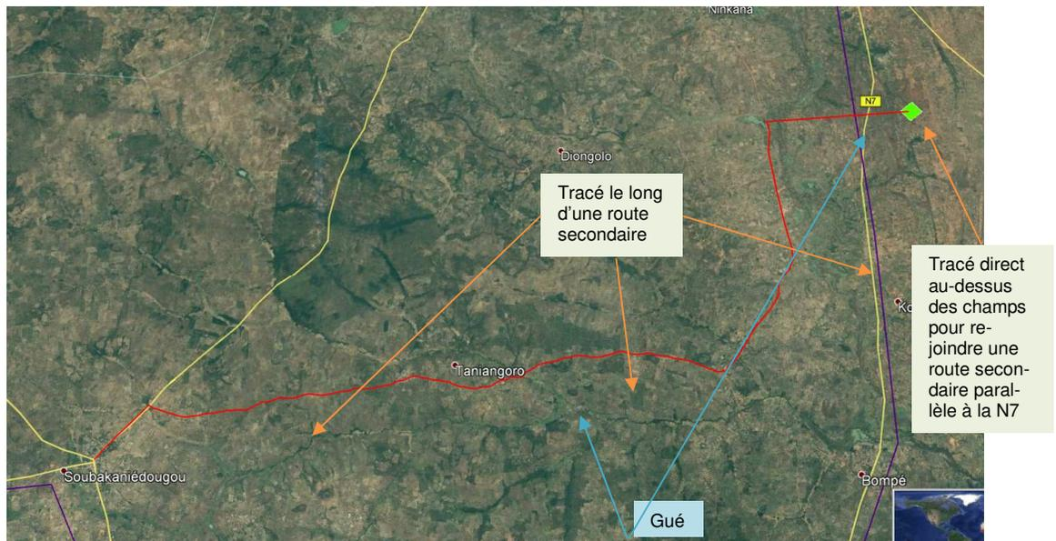
Figure 45 : Détail du tracé potentiel entre le poste de Banfora et Soubakaniédougou (ILF 2019)
