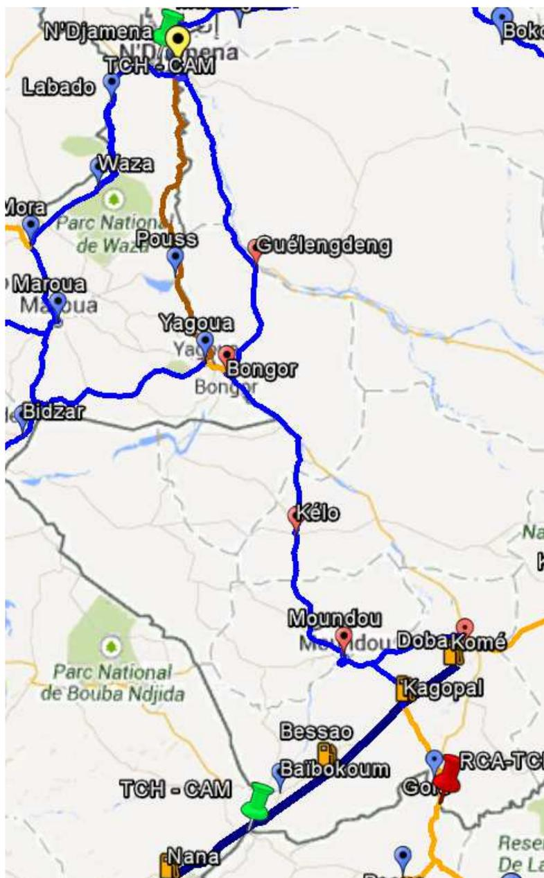
Au niveau de N'Djamena une deuxième interconnexion a été réalisée avec le Cameroun pour sécuriser la liaison établie par le Sud (Mbéré). Un tronçon fibre optique a été posé entre N'Djamena et Kousséri (passant par le pont de Kousséri) pour rejoindre la fibre optique Camtel dans cette localité située en face de N'Djamena. Cette liaison est de type Fast Ethernet 100 Mbit/s (pas d'équipements SDH coté Kousséri).
